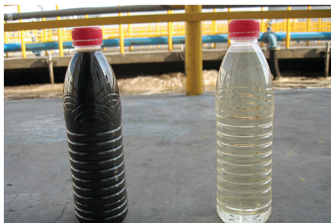
図 5: 水質の比較 - 原水（左） MBR処理水（右）
